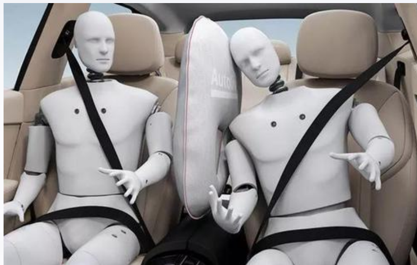
Středový airbag chrání řidiče i spolujezdce
