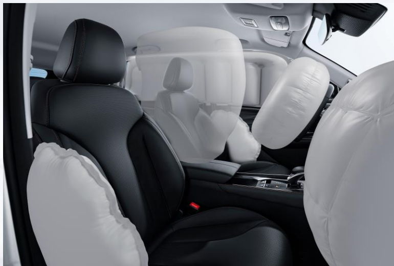
Velké porytí okenního airbagu v rozsahu: 2000 mm
